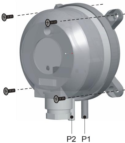
Wichtig: Schläuche dürfen beim Anschließen und Verlegen nicht geknickt oder beschädigt werden. Undichte Schläuche und Schlauchschlüsse verursachen Störungen am Gerät oder liefern falsche Messergebnisse.
