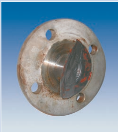
Typické poškození svaru tantalové membrány
