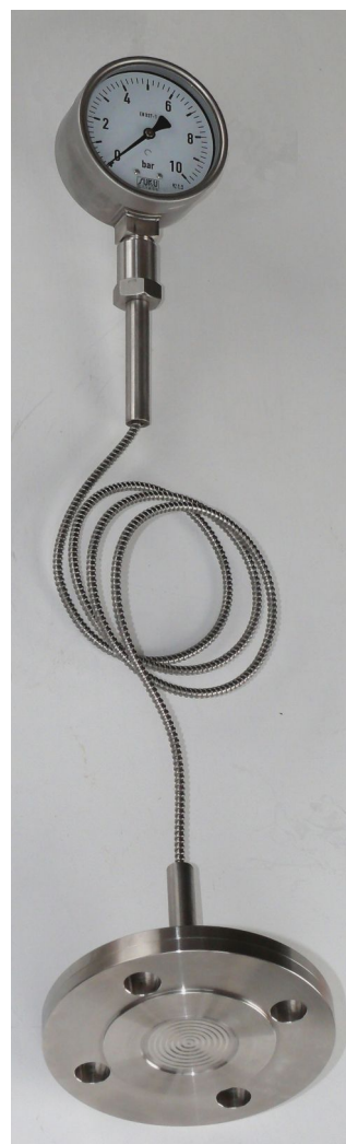
mechanický tlakoměr s membránovým oddělovačem připojeným kapilárou
