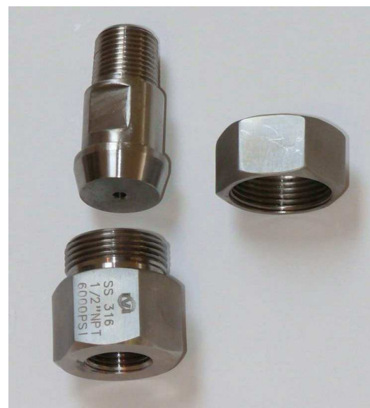
Tlakoměrový adapter (horní a dolní díl těsní v zabroušené kuželové ploše)
